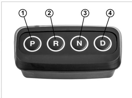
Abb. 26: Bedienfeld Gear Control
